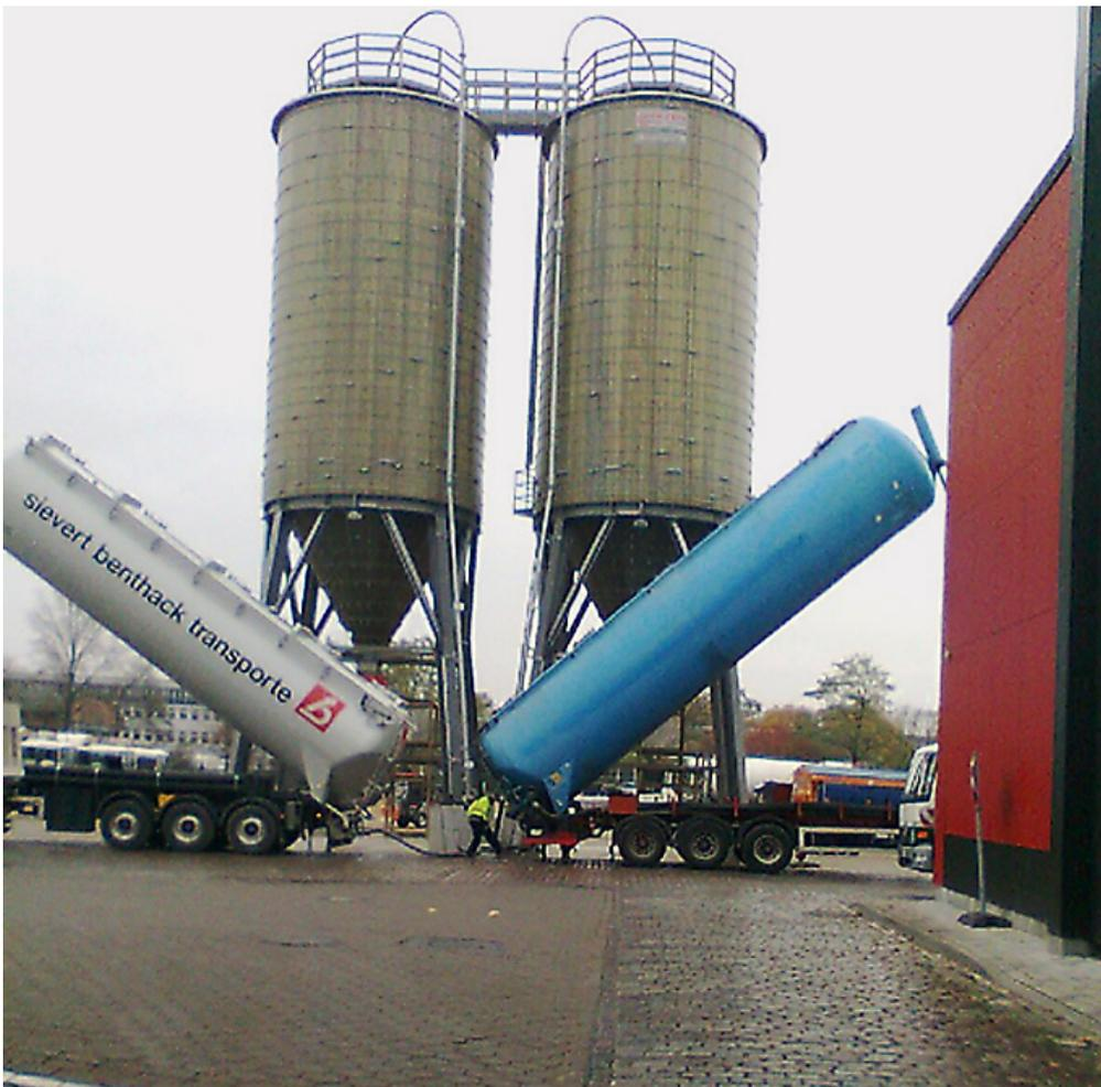
Bild 9: Streusalzsilos werden gefüllt
