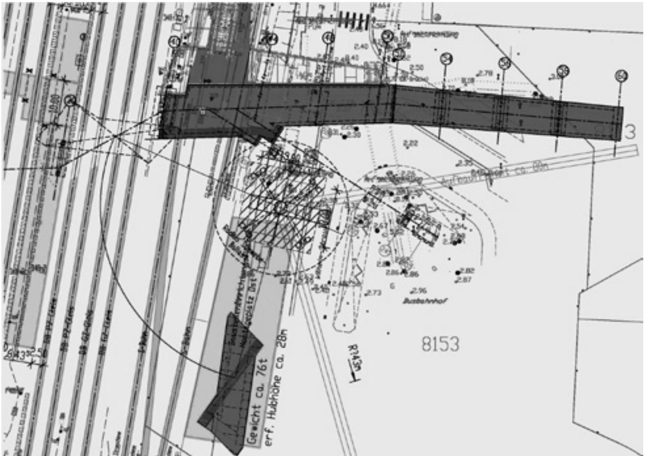
Abb. 12: Baustelleneinrichtungsflächen mit Gleisquerungen
