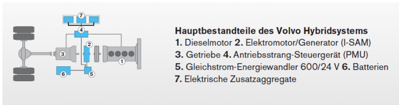
Hauptbestandteile des Hybridsystems
